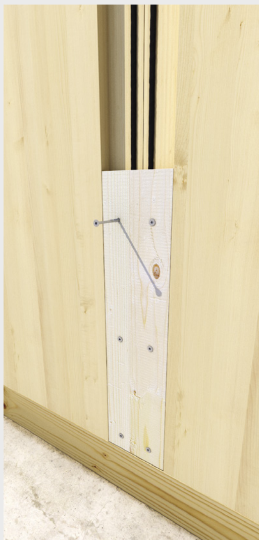
Fissaggio pareti in X-LAM con viti HBS diametro 6 mm.
