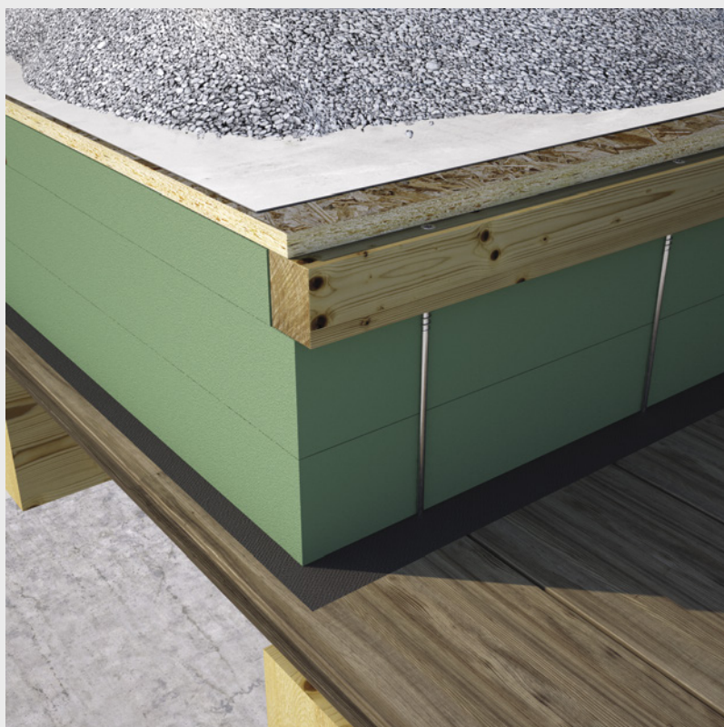
^ Befestigung von hartem Dämmstoff am Flachdach.
