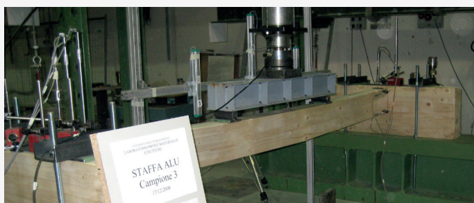
Testy na vzorcích o skutečných rozměrech (připojení hlavní nosník - vedlejší nosník)
