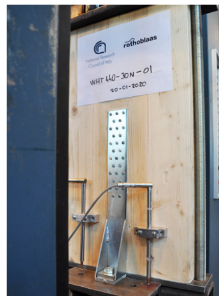
Versuchsreihe an BSP-Platten (C24) (CNR-IBE St. Michael an der Etsch, 2020).
