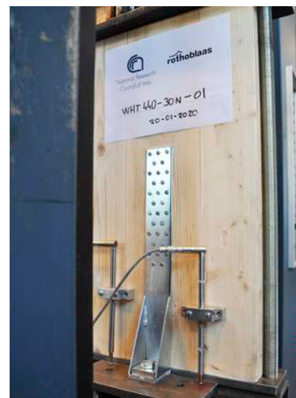
Campagne expérimentale sur panneaux CLT (C24) (CNR-IBE San Michele All'Adige, 2020).
