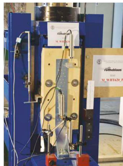
Campaña experimental Seismic-REV en madera GL24h (DICAM-Universidad de Trento y CNR-IVALSA San Michele All'Adige, 2015).
