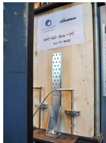
Campaña experimental en paneles de CLT (C24) (CNR-IBE San Michele All'Adige, 2020).
