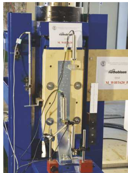
Experimentell kampanj Seismic-REV på limträ GL24h (DICAM-universitetet i Trento och CNR-IVALSA i San Michele All'Adige, 2015).
