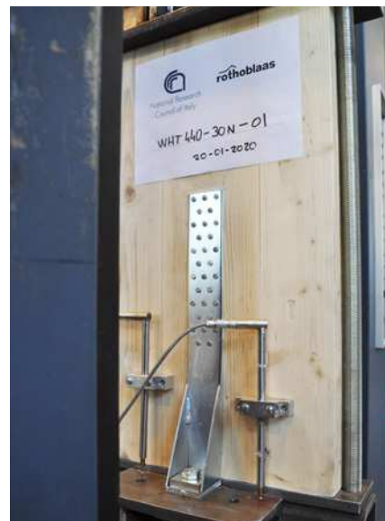
Experimentell kampanj på panelerna av KL-trä (C24) (CNR-IBE i San Michele All'Adige, 2020).
