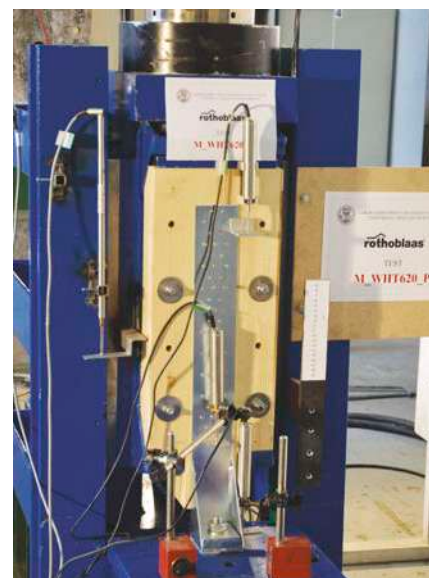
Campanie experimentală Seismic-REV pe lemn GL24h (DICAM-Universitatea din Trento și CNR-IVALSA San Michele All'Adige, 2015).
