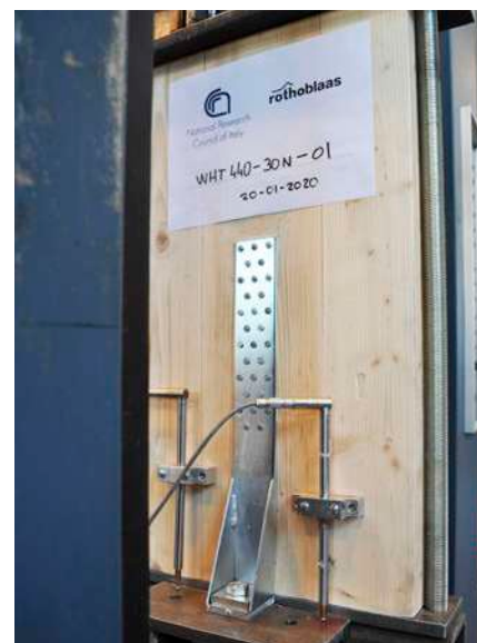
Campanie experimentală pe panouri din CLT (C24) (CNR-IBE San Michele All'Adige, 2020).
