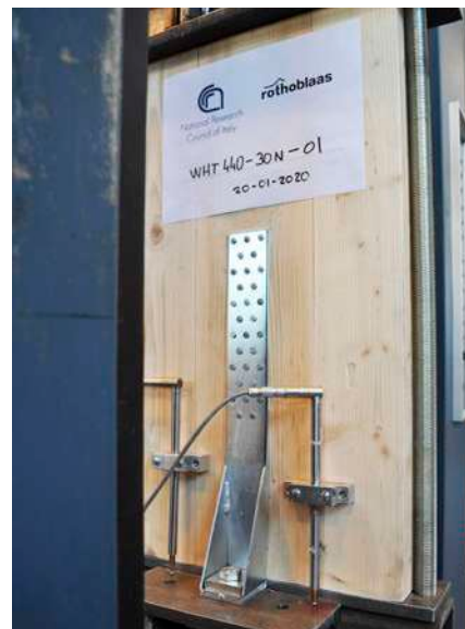
Eksperimentalna kampanja na pločama CLT (C24) (CNR-IBE San Michele All'Adige, 2020).
