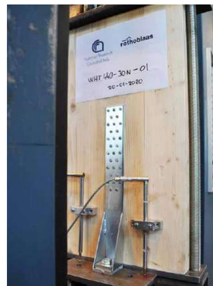
CLT パネル (C24) の実験キャンペーン (CNR-IBESan Michele All'Adige, 2020)。
