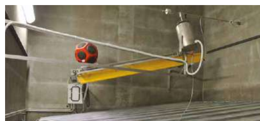
ΦΩΤΟΓΡΑΦΙΑ 1: φωτογραφία δοκιμίου, πλευρά θαλάμου εκπομπής
