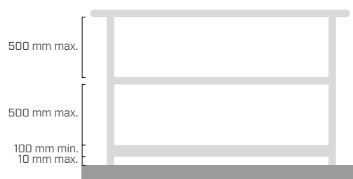
GARDE-CORPS AVEC PLINTHE GARDE-PIEDS
