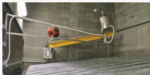
Foto 1: Fotografia da amostra, lado da câmara emissora
