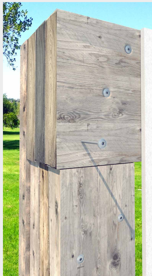
紧固灰泥板覆面的三层，多层梁。
