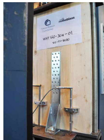
Campanha experimental em painéis CLT (C24) (CNR-IBE San Michele All'Adige, 2020).
