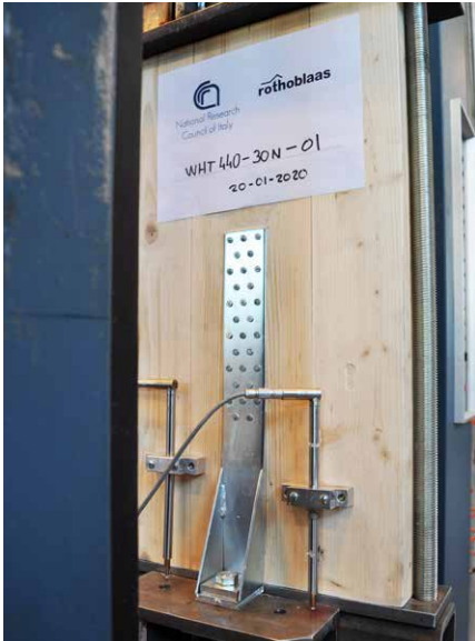
关于 CLT 面板 (C24) 的实验活动 (CNR-IBE San Michele All'Adige, 2020 年)。
