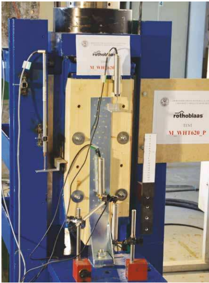
关于 GL24h 胶合木的 Seismic-REV 实验活动 (DICAM-University of Trento 和 CNR-IVALSA San Michele All'Adige, 2015 年)。
