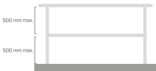
BARANDA SIN RODAPIÉ
