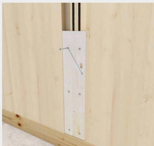
Στήριξη τοιχίων CLT με βίδες HBS διαμέτρου 6 mm.
