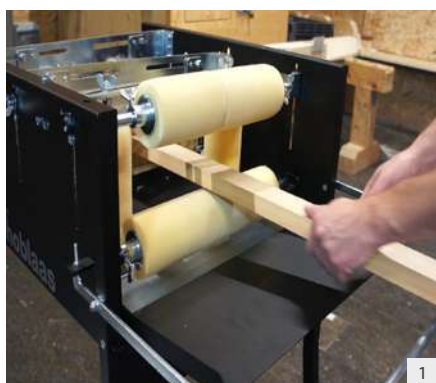
Insérer l'élément entre les deux enduiseuses automatiques
