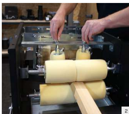
Adapter les éponges aux dimensions de l'élément et les fixer avec des vis.
