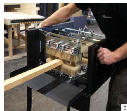
Adapter les balais aux dimensions de l'élément et les fixer avec des vis.
