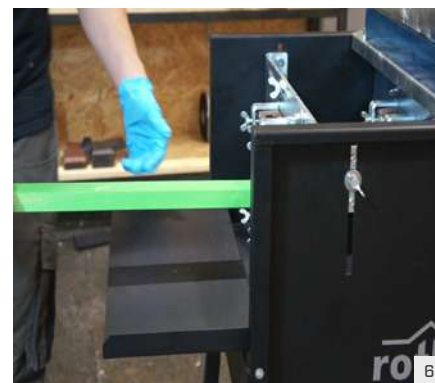
Démarrer le processus : ouvrir les buses et attendre que les rouleaux absorbent la couleur. Enfin, pousser les éléments à travers les éponges.
