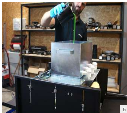
Entrer la peinture ou le produit d'imprégnation. Si nécessaire, mélanger jusqu'à obtenir une consistance homogène.
