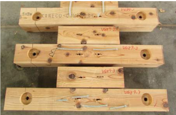
構造用集成材とVGZ9200の荷重-変異曲線（下）と破壊状況（上）
