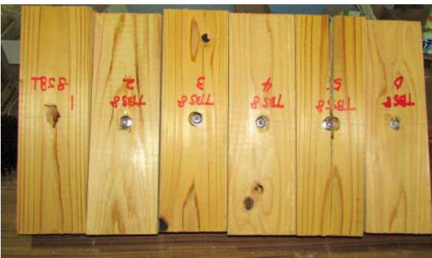
構造用製材とTBS8180の荷重-変位曲線（左）と破壊状況（上）
