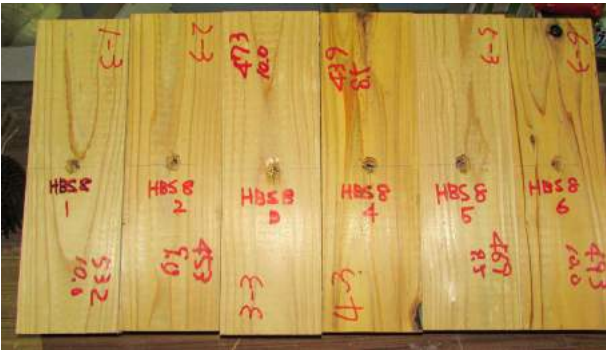
構造用製材とHBS8180の荷重-変位曲線（左）と破壊状況（上）
