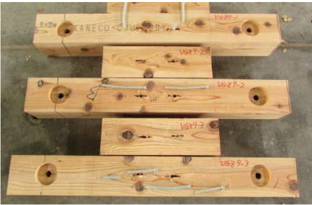
構造用集成材とVGZ9200の荷重-変異曲線（下）と破壊状況（上）
