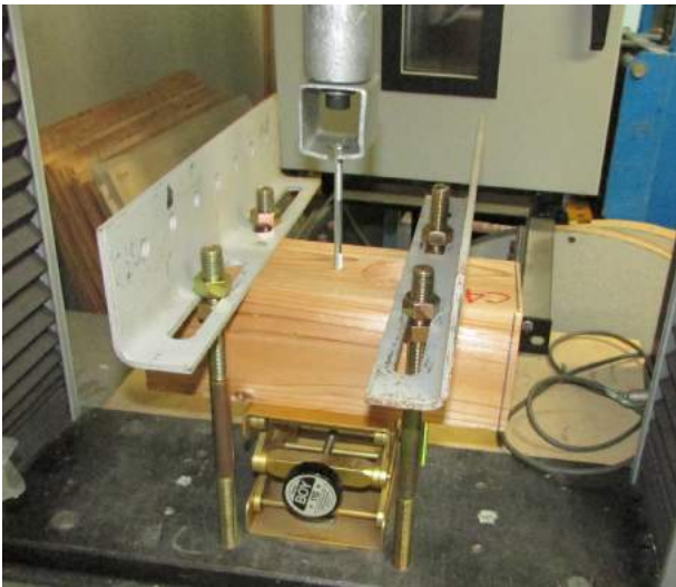
引抜試験実施状況
