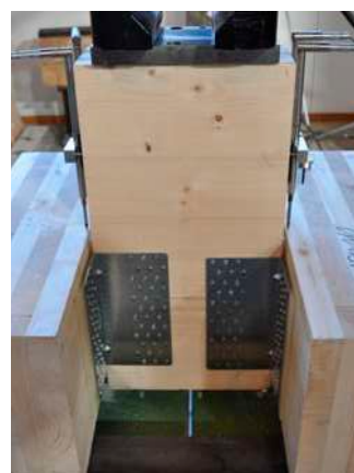
Amostras de ensaio: painéis CLT 5 camadas angulares TITAN com fixação total TTF200 - TTN240 - TTS240 - TTV240 perfil resiliente XYLOFON 35
