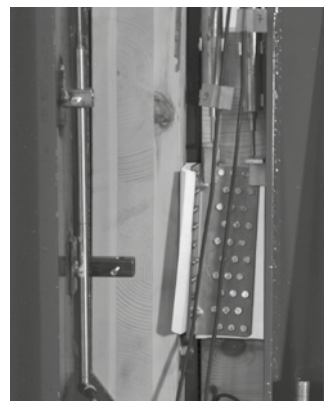
Amostras de ensaio: painéis CLT angular TITAN TTF200
