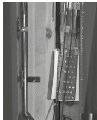
Mostre de încercare: panouri CLT cornier TITAN TTF200
