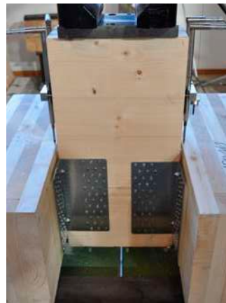
Preskusni vzorci: CLT plošče, 5-slojne kotniki TITAN s celotno pritrditvijo TTF200 - TTN240 - TTS240 - TTV240 elastični profil XYLOFON 35
