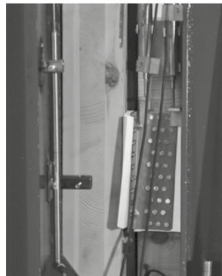
Preskusni vzorci: CLT plošče kotnik TITAN TTF200
