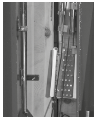
Zkušební vzorky: panely CLT úhelník TITAN TTF200
