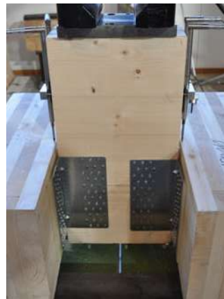
Δείγματα δοκιμής: πάνελ CLT 5 στρωμάτων γωνίες TITAN με πλήρη σύνδεση TTF200 - TTN240 - TTS240 - TTV240 ανθεκτικό προφίλ XYLOFON 35
