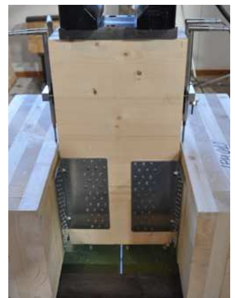
Testinäytteet: CLT-levyt 5 kerrosta TITAN-kulmaraudat täyskiinnityksellä TTF200 - TTN240 - TTS240 - TTV240 joustava profiili XYLOFON 35
