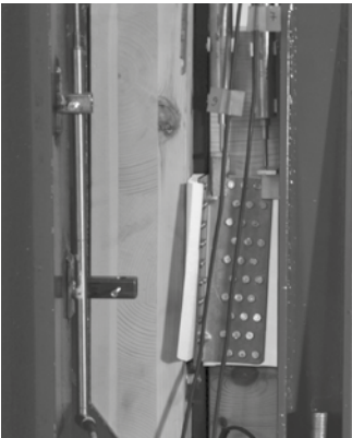
试样： CLT 面板 TITAN TTF200 直角支架
