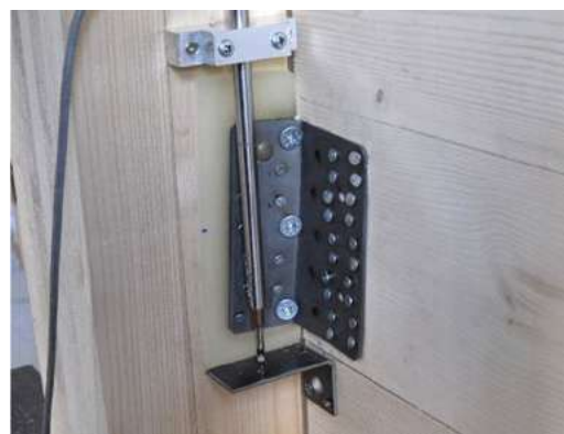
Prova monotona a taglio ( F_{2/3} ) su NINO15080 in configurazione legno-legno.
