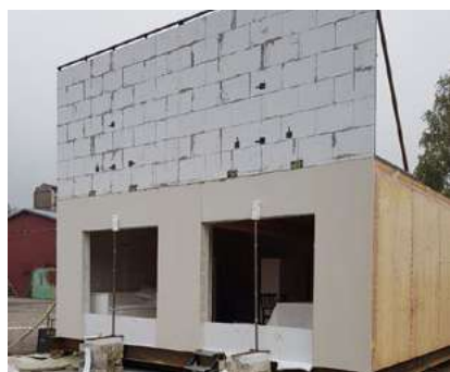
Foto del compartimento a fine montaggio, prima di iniziare il test
