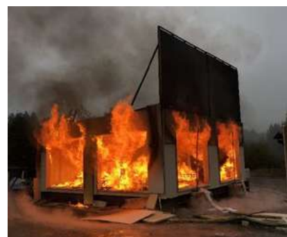
Foto del compartimento durante il test
