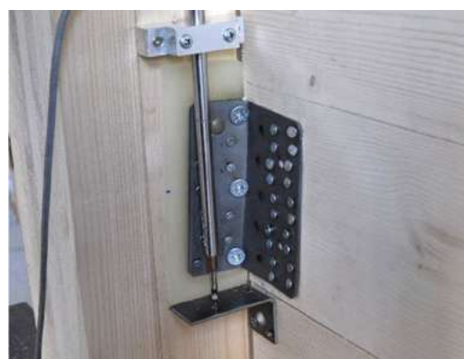
Essai de cisaillement monotone ( F_{2/3} ) sur NINO15080 en configuration bois-bois.
