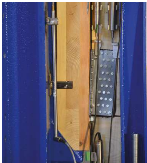
Échantillons d'essai : panneaux en CLT équerre TITAN TTF200
