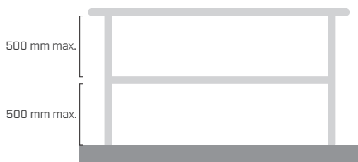
BARANDA SIN RODAPIÉ
