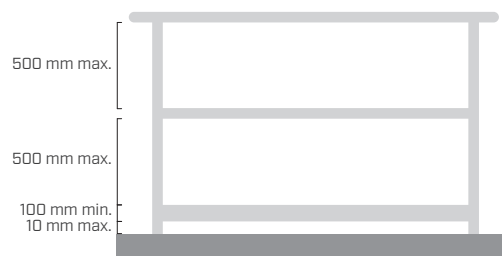
GARDE-CORPS AVEC PLINTHE GARDE-PIEDS
