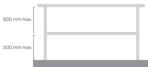
GARDE-CORPS SANS PLINTHE GARDE-PIEDS
