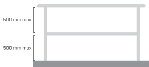
BARANDA SIN RODAPIÉ
