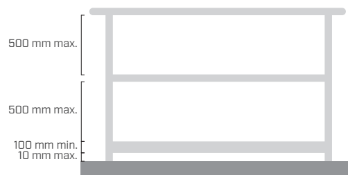
GARDE-CORPS AVEC PLINTHE GARDE-PIEDS
