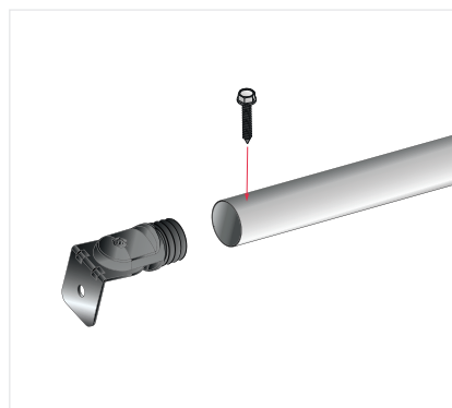
13 - Fissare gli angoli con viti autoforanti 4,8 x 25.
