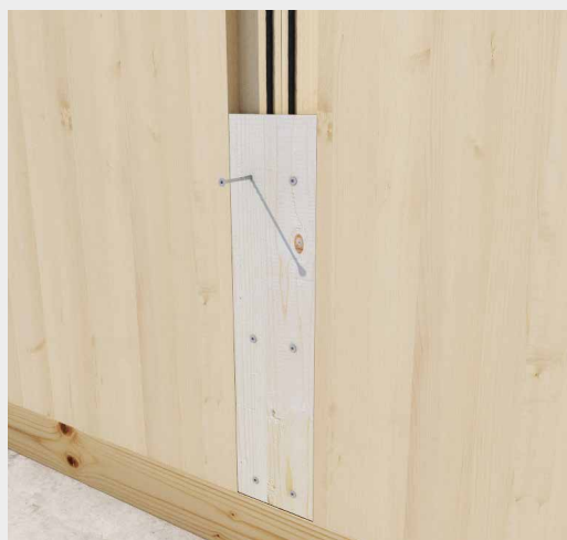
^ Befestigung von BSP-Wänden mit 6 mm HBS.
