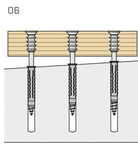
Die anderen Schrauben auf die gleiche Weise justieren, um die Konstruktion korrekt auszurichten.
