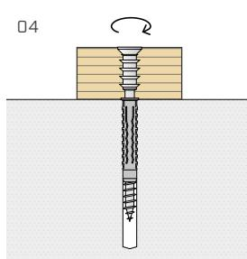
Die Leiste befestigen, indem die Schraube so eingeschraubt wird, dass der Schraubenkopf bündig zum Holzelement verläuft.
