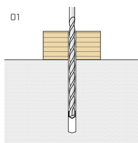
Percer les éléments avec un diamètre  $d_V = 8,0$  mm.
