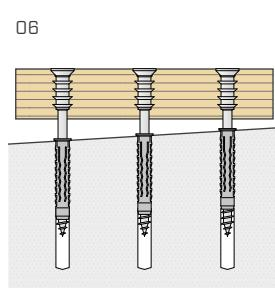
Régler les autres vis de la même manière en vue d'obtenir le nivellement de la structure.
