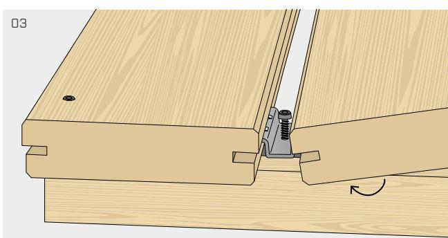
Emboîter la planche suivante en l'insérant dans le connecteur TVM.
