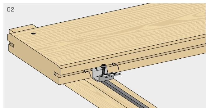
Insérer le connecteur TVM dans la rainure de manière à ce que l'ailette latérale adhère au fraisage de la planche.
