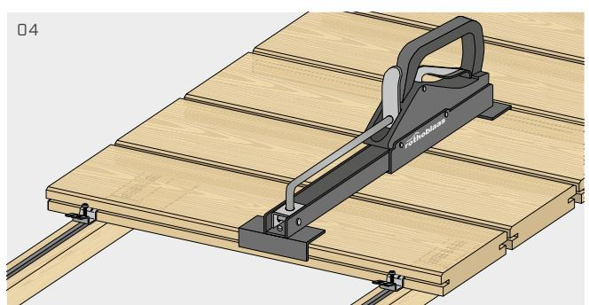
Apretar las dos tablas mediante el sargento CRAB MINI o CRAB MAXI hasta obtener una separación entre las tablas de 7 mm (véase el producto en la pág. 395).
