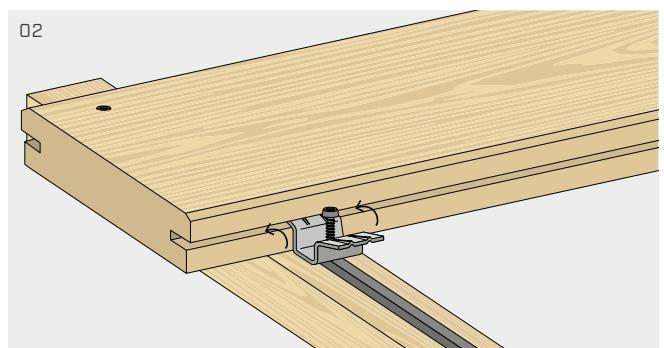
Insertar en la ranura el conector TVM de modo que la aleta lateral quede adherente al fresado de la tabla.
