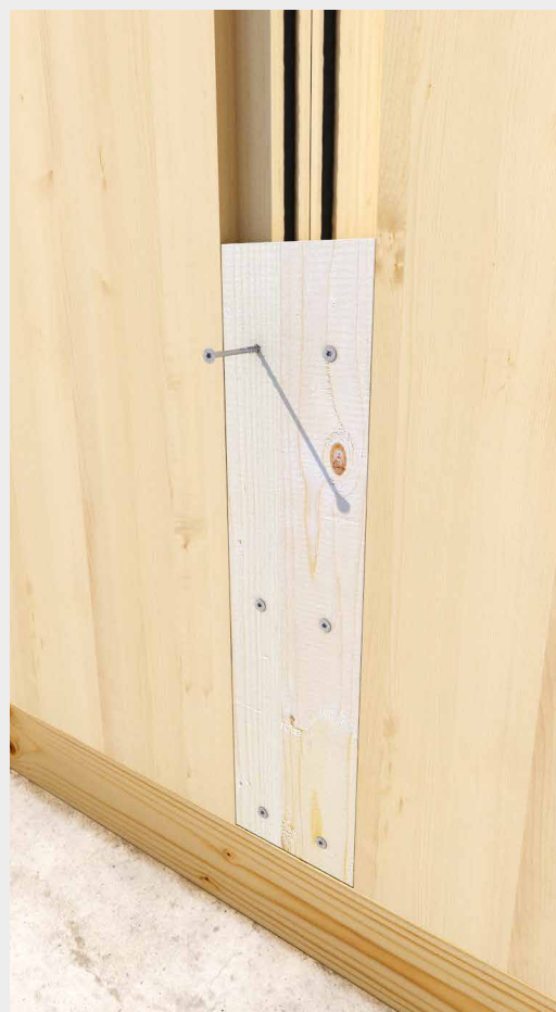
CLT壁-壁のスプライン接合、半ねじHBS径6mm。 >
