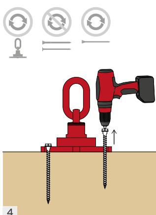
Después de levantar, quitar los tornillos y desecharlos. Solo se pueden utilizar para una única operación de transporte, salvo el VGS PL, que se puede reutilizar para el transporte en condiciones específicas. Consultar las instrucciones.
