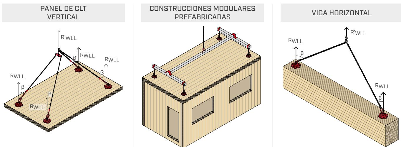
RWLL = capacidad de carga de referencia para un solo anclaje
