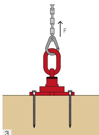
Conectar con el gancho de la grúa y levantar el elemento con cuidado. Prestar atención a los ángulos y las direcciones de elevación permitidas y a las correspondientes capacidades máximas.
