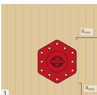
Leer con atención las instrucciones de uso y respetar las indicaciones. La placa se debe colocar en el elemento de madera a transportar respetando las distancias mínimas recomendadas.
