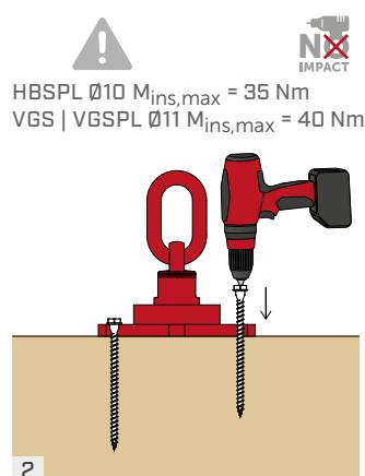
La longitud y la cantidad de tornillos dependen de la aplicación y del peso del elemento a transportar. Se recomienda apretarlos respetando los pares indicados en las correspondientes instrucciones de instalación.
