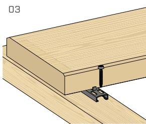
Visser chaque connecteur à la sous-structure par une vis KKTX implantée dans l'un des deux trous oblongs.
