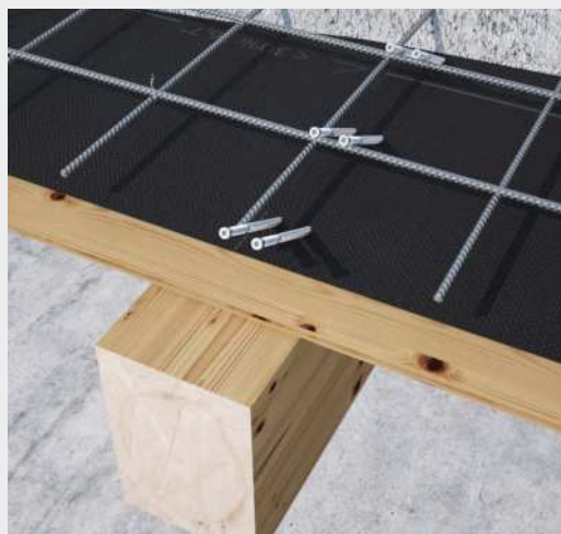
Forjado colaborante madera-hormigón con disposición de conectores a 30° en fila doble.
