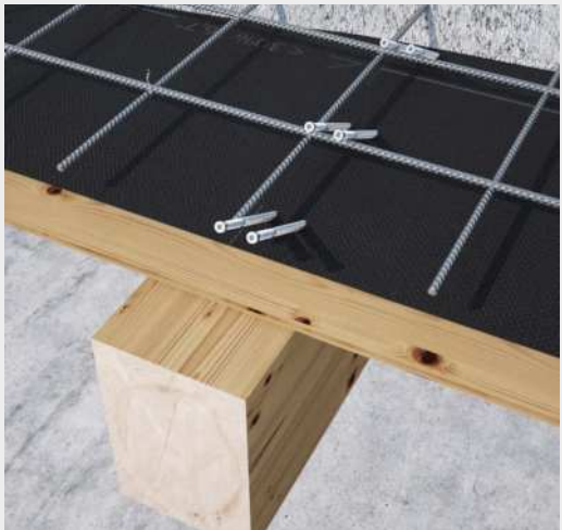
^ CLT 面板上的木-混凝土复合楼板，采用 45°螺钉单排排列。 ^ 木-混凝土复合楼板，采用 30°螺钉双排排列。
