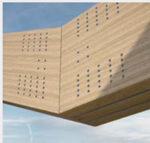
Pevný spoj s kolenom s dvojitou vnútornou platňou (LVL).
