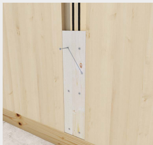
Крепление стен из CLT шурупами HBS диаметром 6 мм.
