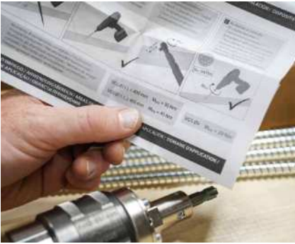
Den für die Schraube vorgesehenen Drehmoment-Grenzwert genau überprüfen.
