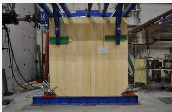
Esempio di output da prova ciclica su sistema parete: diagramma forza-spostamento e setup di prova per pannello singolo
